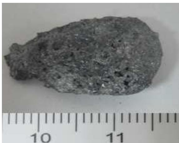
Fig. 1:  $Sn_3Sb_2S_6$  ingot
